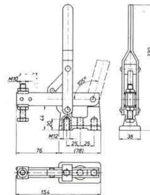
**VERTIKAL-SPANNER** mit massivem Haltearm, alle Teile verzinkt und passiviert, mit Andruckschraube und einsatzgehärteten Lagerbuchsen einschl. Seegerringsicherung, speziell geeignet für unterschiedliche Materialdicken bei gleicher Haltekraft
